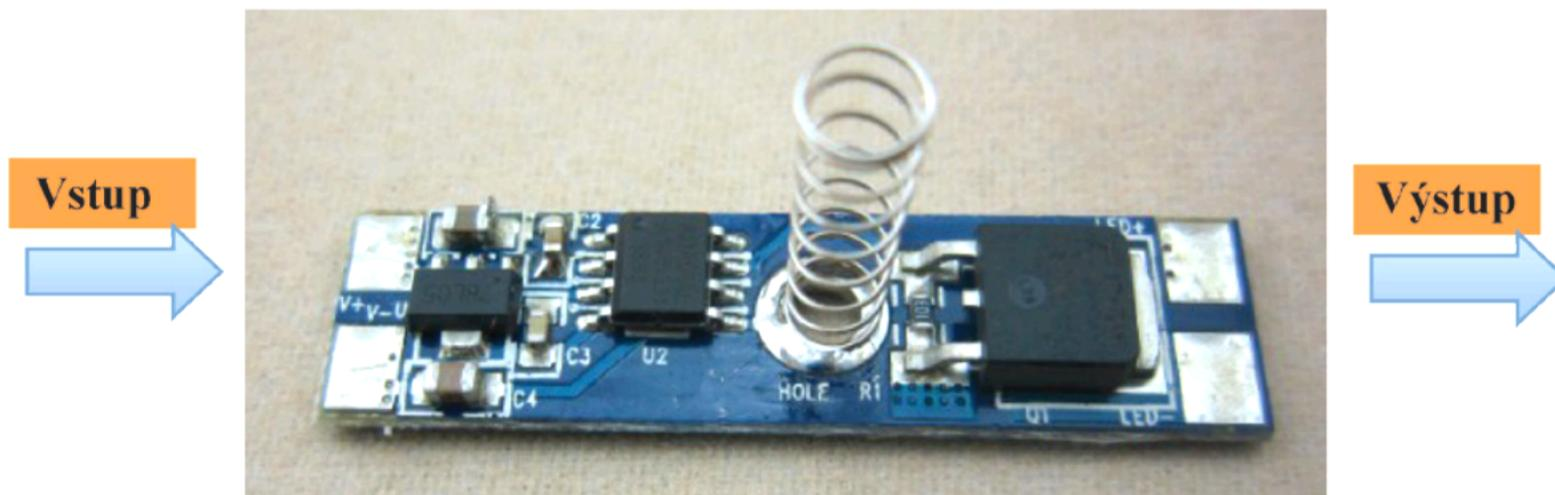
Dotykový stmievač / spínač určený pre priamu montáž do AL profilu. Pre ovládanie funkcií nevyužíva vodivé spojenie s AL profilom, ale ovláda sa pomocou dotyku na difúzora (plexi) v mieste spínača. Dotykové miesto indikuje svietiaci modrá LED.
